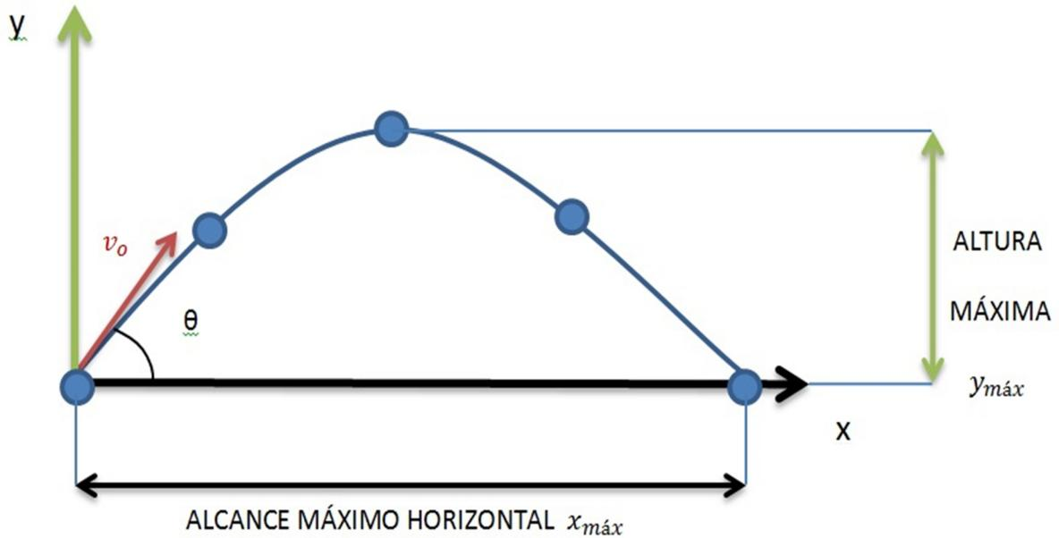
FIGURA 2. DIMENSIONES PRINCIPALES DEL MOVIMIENTO PARABÓLICO.
