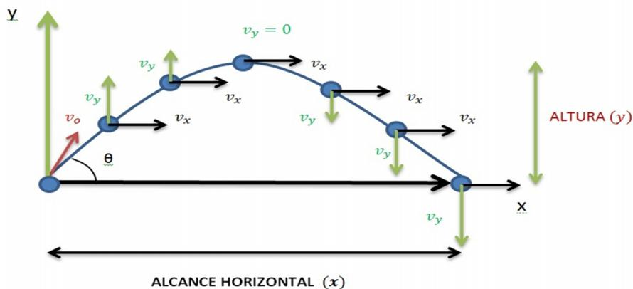
FIGURA 4. DIAGRAMA DEL MOVIMIENTO PARABÓLICO
